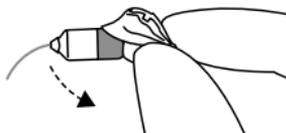
3. Kontrollieren Sie, ob der Dome richtig sitzt, indem Sie den unteren Teil des Domes vorsichtig anheben: Der Kragen muss das Hörerende mit der Einkerbung vollständig umschließen.
