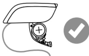
1. Öffnen Sie die Batteriekappe mit dem Fingernagel. Nehmen Sie gegebenenfalls die alte Batterie heraus.
